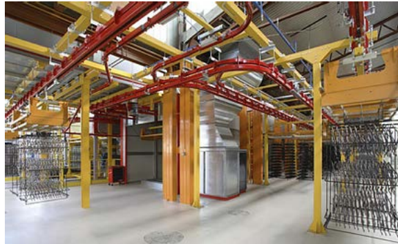
自动化 RFID 生产线通过运输和电泳线追踪产品
